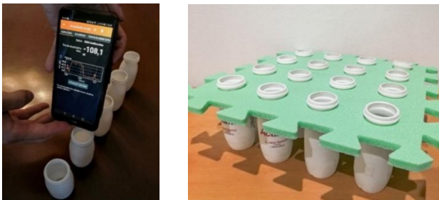
Obr. 3 Vlevo – akustický model STM s pěti lahvičkami (atomy), telefon s viditelnou obrazovkou je přijímač, druhý telefon (skrytý za prvním) je vysílač, mikrofon přijímače a reproduktor vysílače se nacházejí v těsné blízkosti kelímků, vpravo – matice lahviček (atomů) 4×4 s pěnovou šablonou
