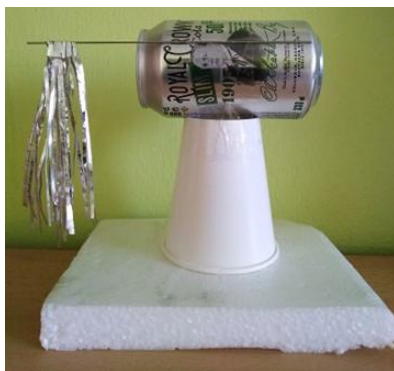
Obr 1 Plechovka na stojánku a s hliníkovými lamelami, které detekují, zda je elektricky nabitá
